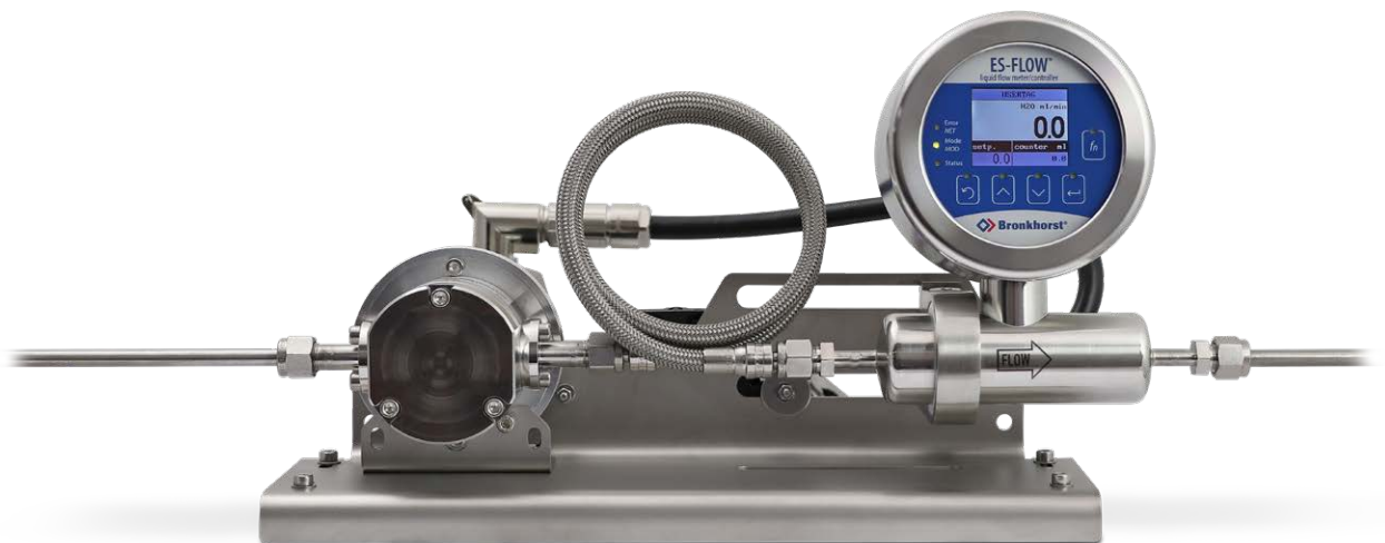
Flüssigkeitsdosiersystem, bestehend aus einem ES-FLOW™-Durchflussmesser mit integriertem PID-Regler, der eine mechanisch und elektrisch verbundene Pumpe direkt antreibt
